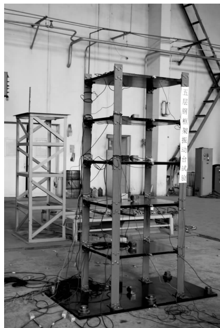
图 2 试验模型及传感器布置图
