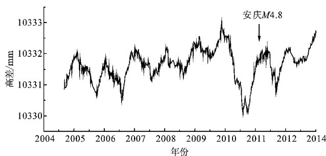
图5 安庆地震前后肥东台定点短水准变化特征曲线
