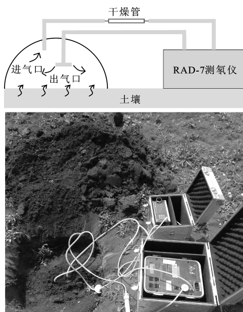
图2 土壤气 Rn 通量野外测量装置及其测量示意图
