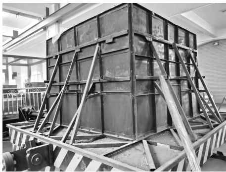
图 1 振动台及实验模型箱 Fig. 1 Shaking table and experimental box model
