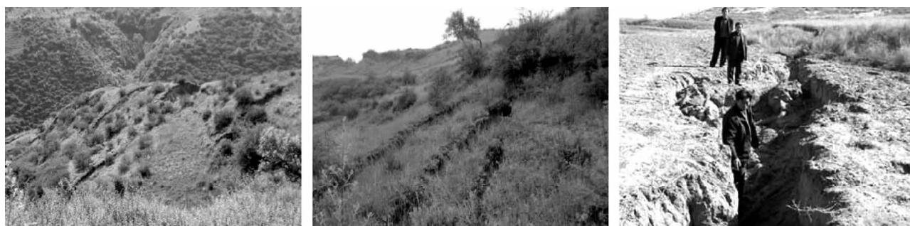
图3 煤矿开采引起的土地裂缝
