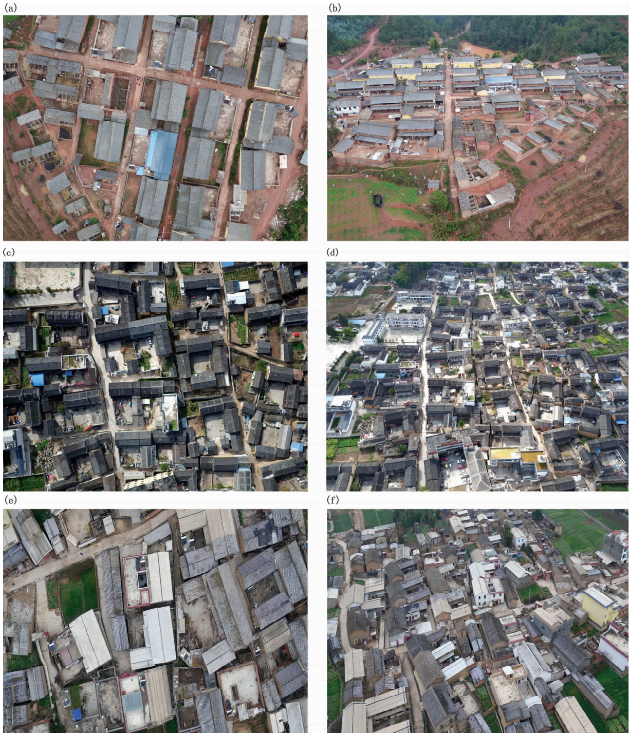
图4 楚雄州双柏县妥甸镇洒利黑村正射影像 (航高 100 m) (a) 及倾斜摄影影像 (航高 60 m) (b); 保山市施甸县仁和镇正射影像 (航高 150 m) (c) 及倾斜摄影影像 (航高 150 m) (d); 玉溪市 易门县六街镇茶树村正射影像 (航高 100 m) (e) 及倾斜摄影影像 (航高 80 m) (f)
