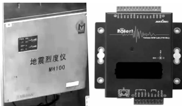
图 4 MEMS 地震观测设备
