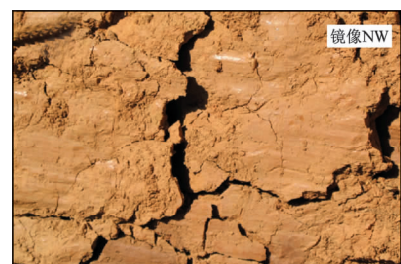
(e) NE 向断层切割红土, 断层滑动面见近水平擦痕
