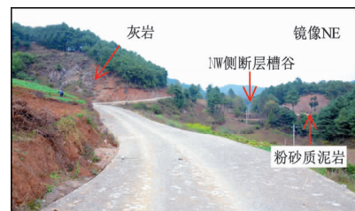
(c) NW 侧断层槽谷照片
