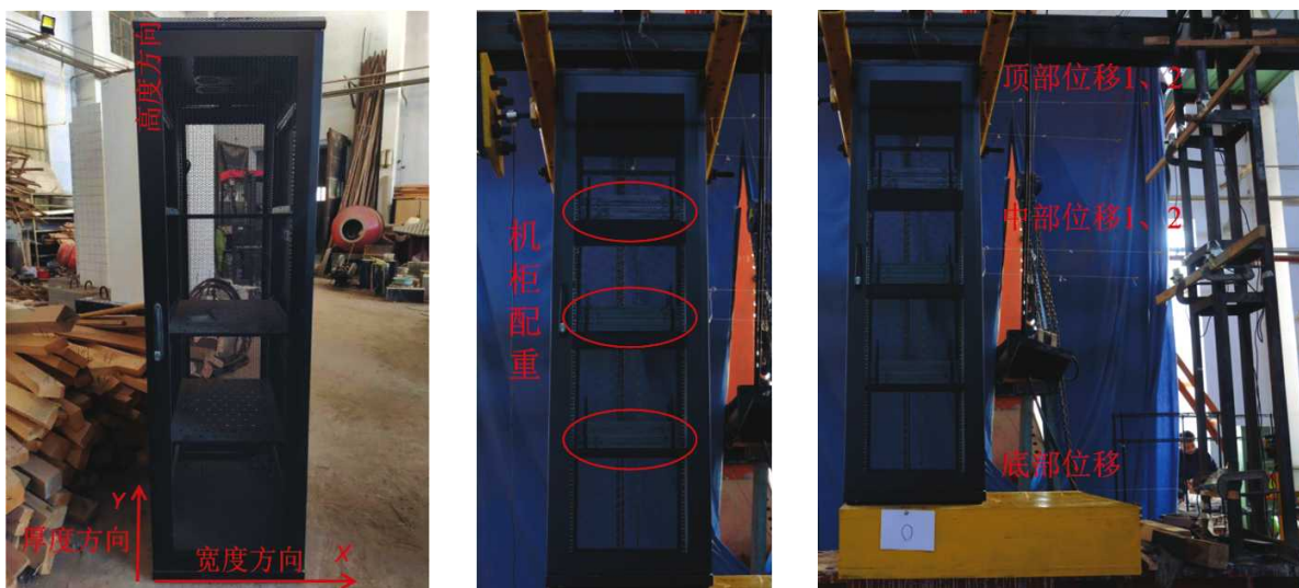
图 2 试验机柜 (a)、配重 (b) 及传感器布置 (c)
