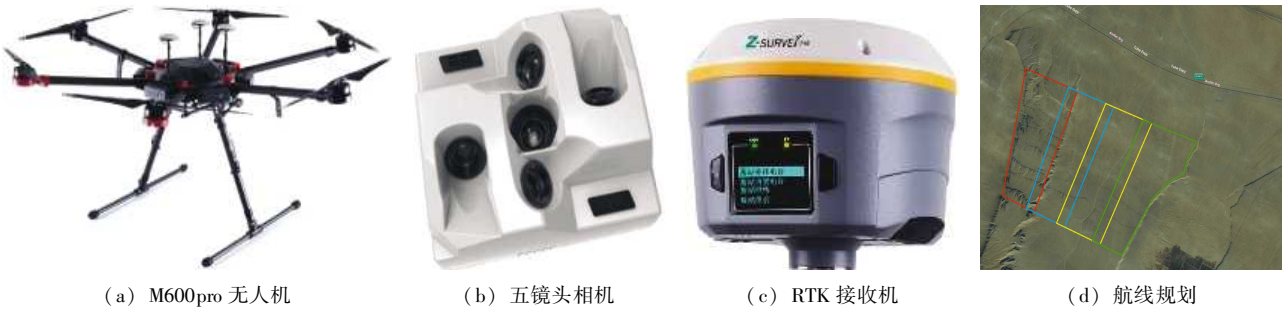
图 3 倾斜摄影数据采集设备（a、b、c）与航线规划图（d）
