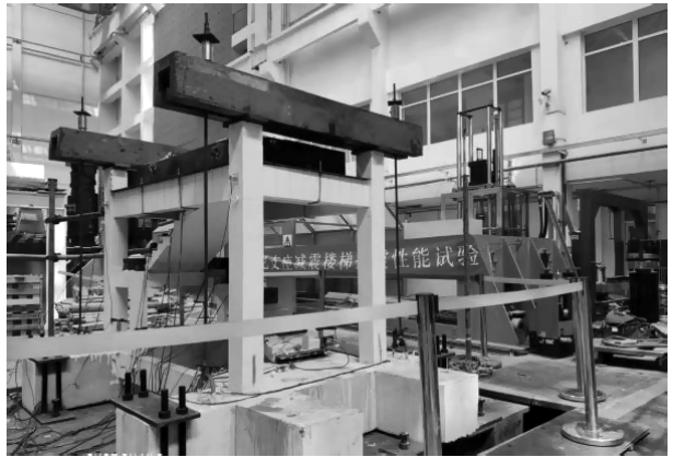
图 3 振动台试验模型
