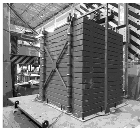
图6 地震模拟振动台(3 m×3 m)与层状剪切模型箱(据张熙胤等,2022a)
